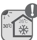
En modo de refrigeración, no establezca una temperatura ambiente demasiado baja, y mantenga la diferencia de temperatura entre las unidades interior y exterior dentro de un rango de 5 grados.
