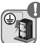
Asegúrese de que la unidad pueda conectarse a tierra adecuadamente al enchufarla para evitar casos de electrocución. No conecte el cable de tierra a una tubería de gas o agua, a un pararrayos o a una línea telefónica.
