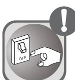
Si percibe alguna anomalía (por ejemplo, olor a quemado), apague la unidad, desconecte la alimentación principal y póngase inmediatamente en contacto con el centro de servicio técnico designado por Daitsu. Si la anomalía persiste, la unidad puede sufrir daños y provocar electrocución o incendios.
