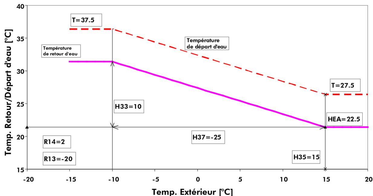
La température minimale d'utilisation de la PAC **SPH-R** pour cette application est limitée par le paramètre R 13 à -20°C. La température de départ d'eau est toujours inférieure aux limites, l'unité peut fonctionner avec la chaudière, jusqu'à -20°C. La température d'autorisation de démarrage de la chaudière est déterminée à partir de la puissance de la PAC **SPH-R** (Point d'équilibre).
