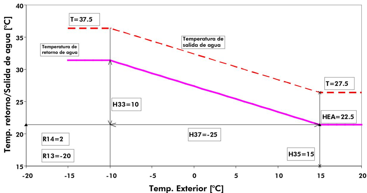
La temperatura mínima de utilización de la **PAC+R** para esta aplicación está limitada por el parámetro R13 a -20°C. La temperatura de salida de agua siempre es inferior a los límites; la unidad puede funcionar con la caldera hasta -20°C. La temperatura de autorización de arranque de la caldera se determina a partir de la potencia de la **PAC+R** (Punto de equilibrio).
