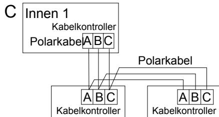
Es gibt drei Methoden zur Verbindung des Kabelkontrollers mit den Inneneinheiten.
