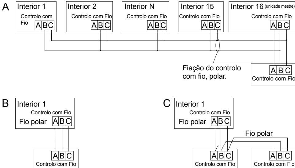
Existem três métodos para ligar o controlo com fio com as unidades interiores.
