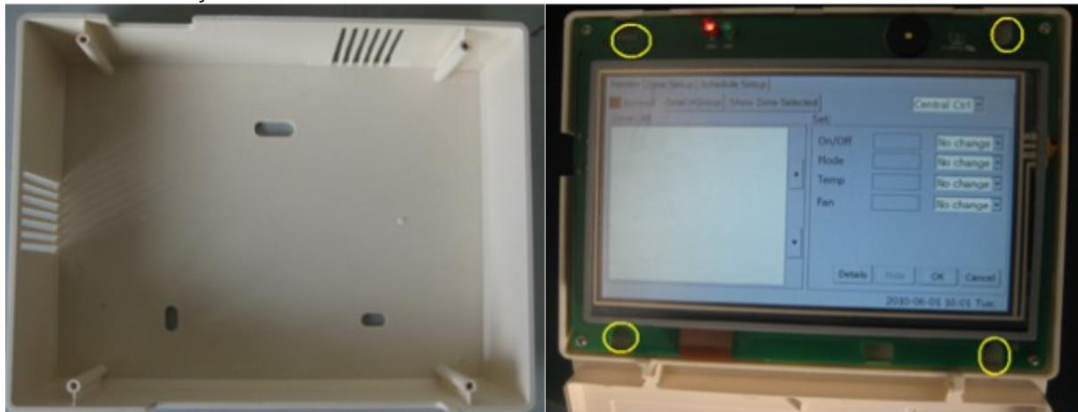
Après avoir effectué les branchements, insérer le contrôleur central dans la façade arrière, ouvrir la façade avant, fixer le contrôleur central sur la façade arrière à l'aide de 4 vis conformément aux images ci-dessus, puis recouvrir la façade avant.
