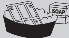
Lassen Sie den Filter gründlich vor der erneuten Installation trocknen. Kontaktieren Sie im Bedarfsfall das Fachpersonal für die Reinigung.
