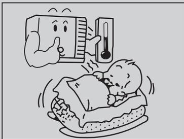
Ne pas utiliser de chauffage près du climatiseur. Les pièces en plastique du climatiseur risquent de fondre si elles sont exposées à une chaleur excessive.
