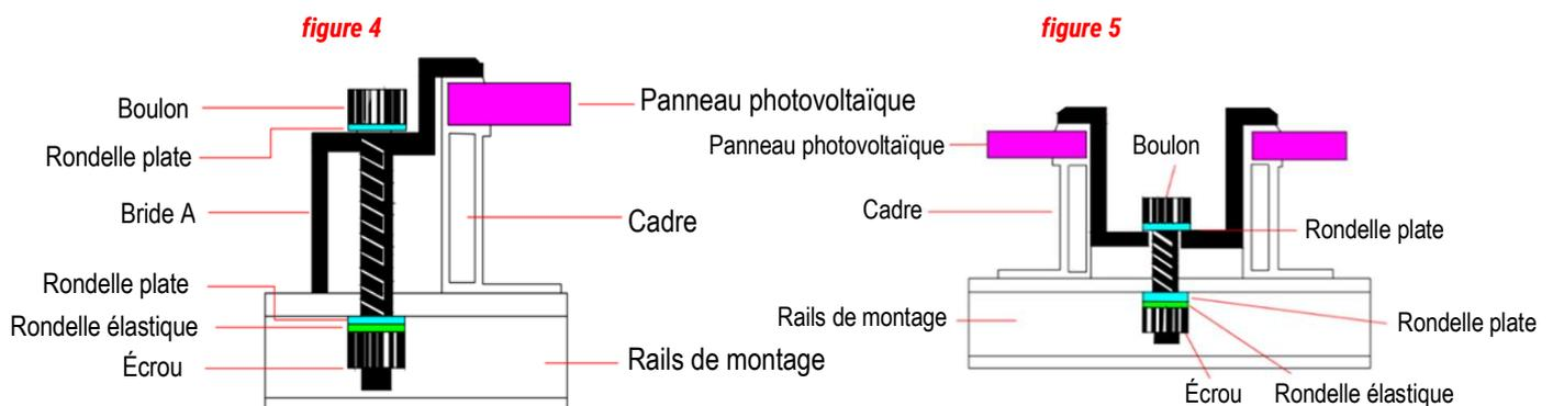
**Méthode de pose : Boulonnage (via trous de fixation du module PV)**
