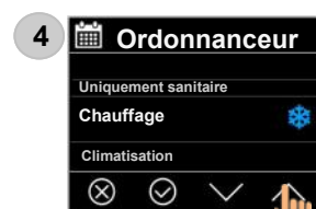
Sélectionner: • Chauffage • Refroidissement • Uniquement sanitaire
