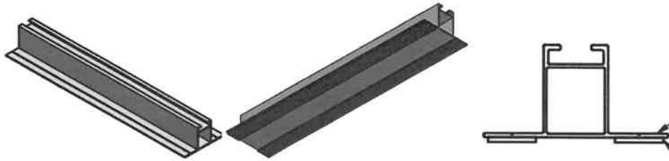
La pièce en EPDM est pourvue d'une partie adhésive en sous face (protégée par un ruban adhésif), ce qui permet le positionnement du rail court et un maintien provisoire avant vissage
