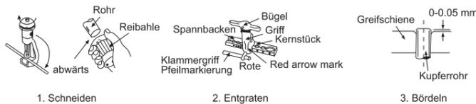
Bei einer guten Bördelung wird die innere Oberfläche des Stutzens glatt und glänzend und von gleichmäßiger Dicke sein. Da die Bördel mit den Verbindungsstücken in Kontakt kommen, prüfen Sie bitte die Bördelausführung sorgfältig.
