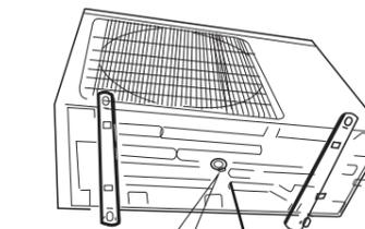
Installez le tuyau de telle manière que son angle permette un flux aisé du drainage.
