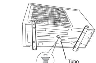
Installare il tubo ad un'angolazione tale da permettere la fuoriuscita dell'acqua.
