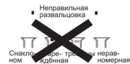
При правильной развальцовке внутренняя обработанная поверхность будет блестящей и иметь одинаковую толщину по всему диаметру. Поскольку именно эта часть будет контактировать с соединениями, следует убедиться, что развальцовка сделана качественно и равномерно.
