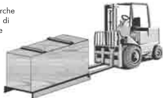
inferiore dell'unità, non si deve dimenticare di togliere le forche prima di sollevare la macchina per installarla sul basamento.
