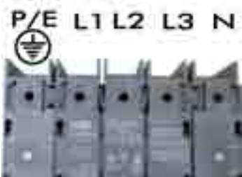
Den Anschluss mit einem Sechskant-Einsteckschlüssel 4mm vornehmen.
