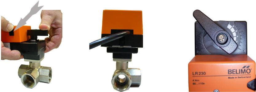
Dévisser la vis au centre de la commande manuelle et désaccoupler le moteur de la vanne.
