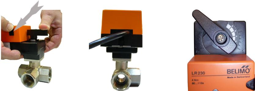
Dévisser la vis au centre de la commande manuelle et désaccoupler le moteur de la vanne.
