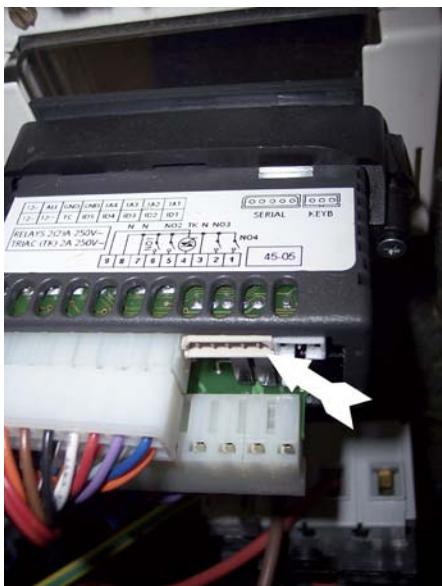
Brancher la clef de programmation sur l'arrière du contrôleur avec le câble fourni
