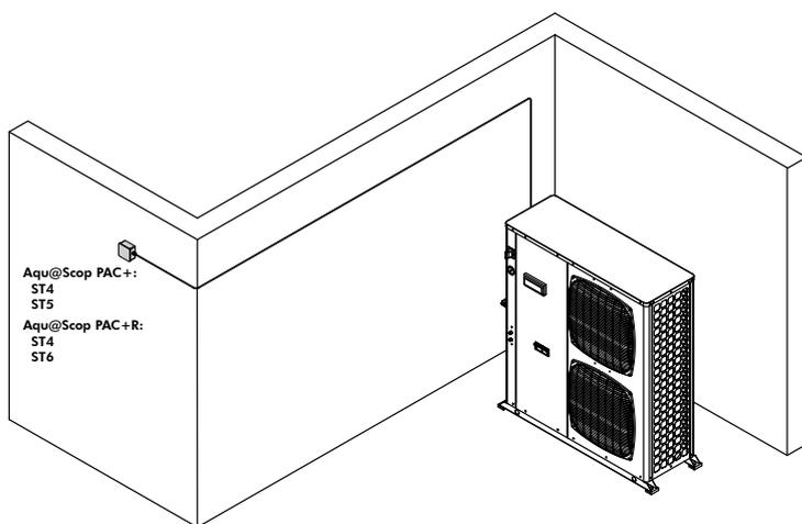
Le boîtier sondes extérieures devra être disposé de façon à ne pas subir d'influence thermique directe.
