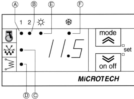
Le dispositif est en mesure de communiquer n'importe quel type d'information inhérente à son état, sa configuration, les alarmes par le biais d'un afficheur et des leds qui sont présentés sur la partie frontale.
