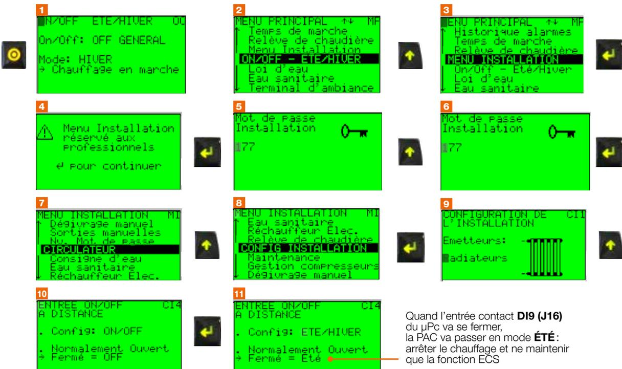
Quand l'entrée contact **DI9 (J16)** du µPc va se fermer, la PAC va passer en mode **ÉTÉ**: arrêter le chauffage et ne maintenir que la fonction ECS
