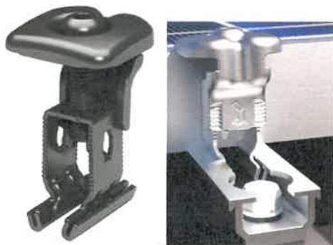
**Cette bride s'adapte à toutes les hauteurs de modules cadrés de 30 à 50 mm et toutes les fonctions (serrage central et d'extrémité avec rotation de la tête à 90°). Disponible en noir et argent. Le pied à clipser est compatible avec tous les rails Renusol.**
