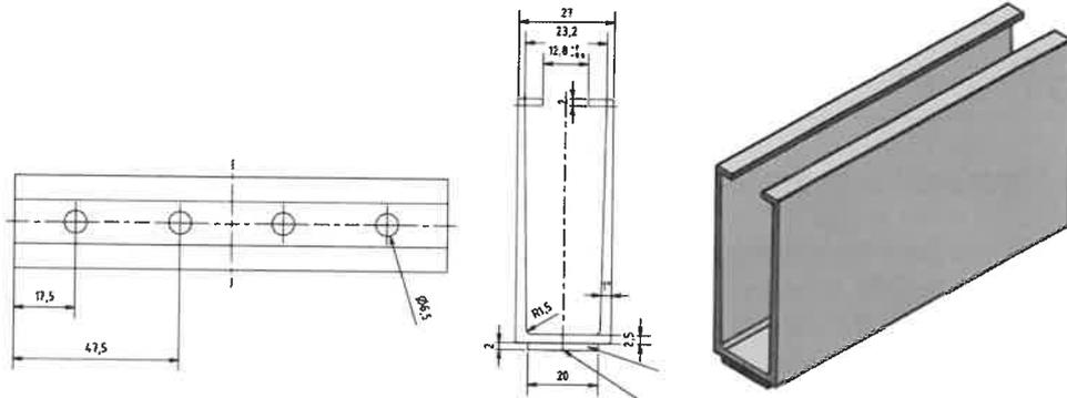
La pièce en EPDM est pourvue d'une partie adhésive en sous face (protégée par un ruban adhésif), ce qui permet le positionnement du rail court et un maintien provisoire avant vissage
