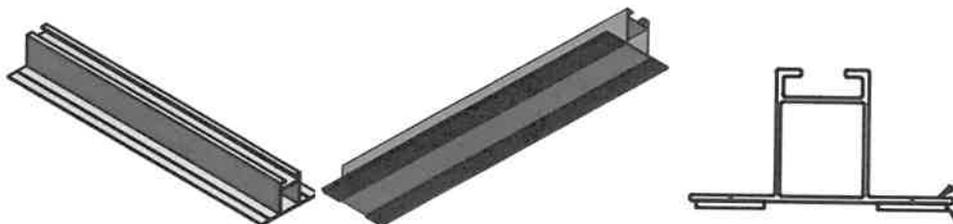
La pièce en EPDM est pourvue d'une partie adhésive en sous face (protégée par un ruban adhésif), ce qui permet le positionnement du rail court et un maintien provisoire avant vissage
