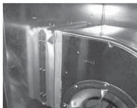
Schutzgitter für Motorantrieb
