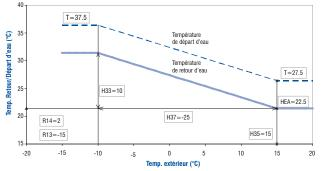
Si la température d'eau de retour calculée par la loi d'eau ne peut pas être obtenue par le compresseur seul, le régulateur demande les appoints électriques. La puissance des résistances d'appoint est divisée en deux étages 2+4 kW. Ces appoints ne peuvent s'enclencher que si les conditions suivantes sont réunies :
