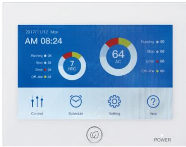
**Cette commande permet de contrôler l'état des unités intérieures et de les piloter à distance!**
