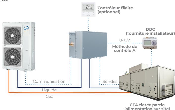
Remarque : la télécommande filaire est en option. Si le DDC peut fournir le signal 0-10V, le marche/arrêt, le mode et la vitesse de ventilation par contacts secs au kit CTA, il n'est pas nécessaire de connecter la télécommande filaire. Dans le cas contraire, la télécommande filaire est nécessaire.
