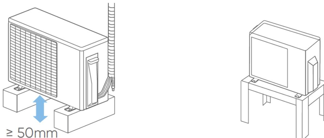
1. Installer l'unité horizontalement (ne pas l'incliner de plus de 3 degrés). S'assurer lors de la pose des fondations d'avoir suffisamment d'espace pour installer les raccordements frigorifiques.
