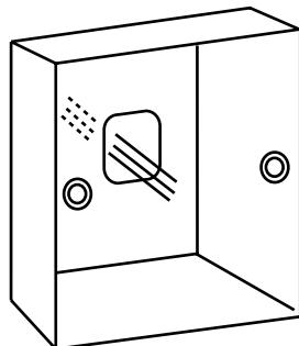
3. Fastgør bagdækslet til holderen. Tilslut derefter kommunikationsledningen til CON1-porten på den kablede kontroller. Sæt til sidst frondækslet på den kablede kontroller til bagdækslet for at fuldføre installationen.
