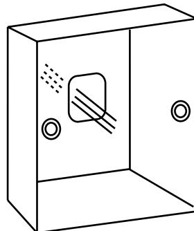
3. Fissare il coperchio posteriore alla staffa. Quindi, collegare il cavo di comunicazione alla porta CON1 del controllore cablato. Infine, posizionare il coperchio anteriore del controllore cablato sul coperchio posteriore per completare l'installazione.
