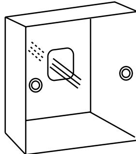
3. Befestigen Sie die hintere Abdeckung an der Halterung. Schließen Sie dann das Kommunikationskabel an den Anschluss CON1 der verdrahteten Steuerung an. Bringen Sie schließlich die vordere Abdeckung des verdrahteten Steuergeräts an der hinteren Abdeckung an, um die Installation abzuschließen.
