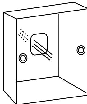
3. Fixe a tampa traseira ao suporte. De seguida, ligue o cabo de comunicação à porta CON1 do controlador com fios. Finalmente, coloque a tampa frontal do controlador com fio na tampa traseira para concluir a instalação.
