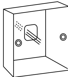
3.Fixer le couvercle arrière sur le support. Ensuite, connectez le fil de communication au port CON1 du contrôleur câblé. Enfin, remettre le couvercle avant du contrôleur câblé sur le couvercle arrière pour terminer l'installation.
