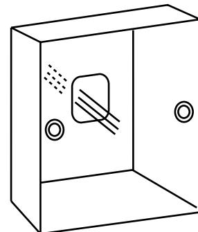
3. Przymocuj tylną pokrywę do uchwytu. Następnie podłącz przewód komunikacyjny do portu CON1 sterownika przewodowego. Na koniec załącz przednią pokrywę sterownika przewodowego na tylną pokrywę, aby zakończyć instalację.
