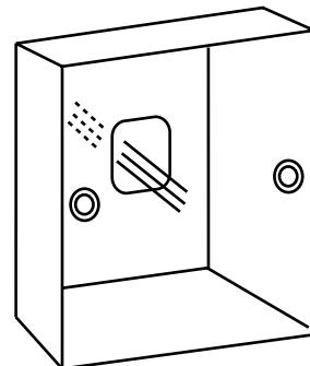
3. Bevestig de achterklep op de houder. Sluit daarna de communicatiedraad aan op de CON1-poort van de bedrade controller. Plaats ten slotte de voorkant van de bedrade controller op de achterkant om de installatie te voltooien.
