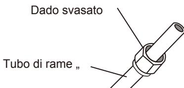
4. Rimuovere il nastro in PVC dalle estremità del tubo quando è pronto per eseguire lavori di svasatura.
