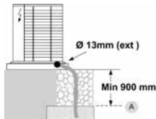
Pour empêcher l'eau de geler en aval de l'évacuat enterrer le tuyau en dessous de la ligne de gel (A)
