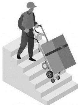
Per spostare lo scaldacqua, utilizzi un carrello a mano e si assicuri che l'inclinazione dello scaldacqua non superi i 45°.
