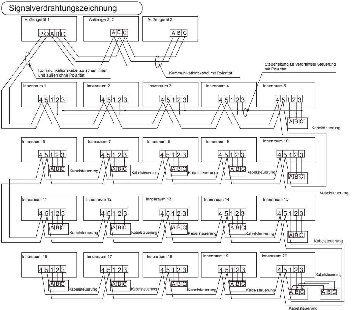
Außengeräte sind über drei Leitungen mit Polarität parallel geschaltet. Das Hauptgerät, die Zentralsteuerung und alle Innengeräte sind über zwei Leitungen ohne Polarität parallel geschaltet.
