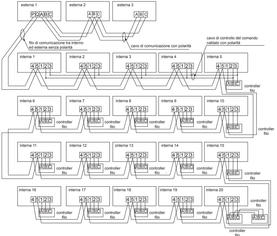
Le unità esterne sono collegate in parallelo tramite tre linee con polarità. L'unità principale, il controllo centrale e tutte le unità interne sono collegate in parallelo tramite due linee senza polarità.
