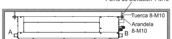
Utilice un medidor de gradiente para garantizar que el nivel de unidad esté dentro de 5mm; Si se utiliza el extremo a para drenar el agua, asegúrese de que el extremo b es un poco más alto que el extremo a para facilitar el drenaje.
