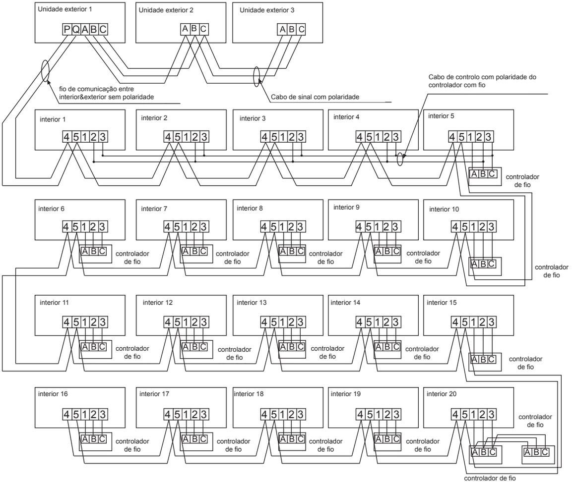
As unidades exteriores são conectadas em paralelo entre si através de três cabos com polaridade. A unidade mestre é conectada a todas as unidades interiores em paralelo entre si através de dois cabos sem polaridade.
