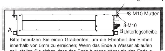
Bitte benutzen Sie einen Gradienten, um die Ebenheit der Einheit innerhalb von 5mm zu erreichen; Wenn das Ende a Wasser ablaufen soll, stellen Sie sicher, dass das Ende b etwas höher als das Ende a ist, um den Abfluss zu erleichtern.
