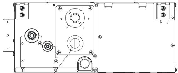
Öffnen oder Schließen der Wassereinspritzöffnung durch Drehen des Lochstopfens
