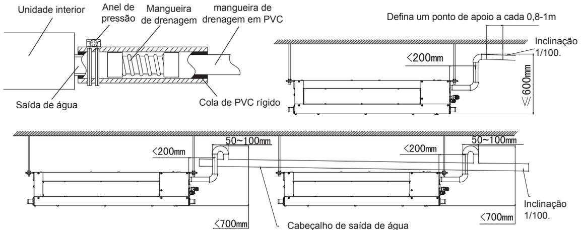
Múltiplas unidades utilizam a cabeça de saída de água para drenar a água para a vala de drenagem
