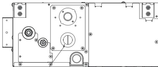
Ouvrir ou fermer le trou d'injection d'eau en tournant le bouchon du trou.
