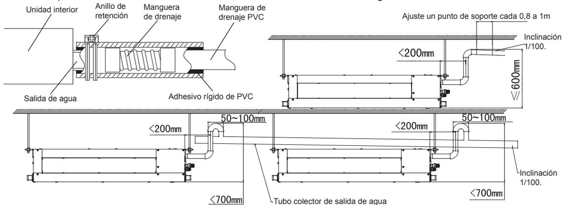
Múltiples unidades utilizan un tubo colector de salida de agua para drenar el agua en zanja de drenaje
