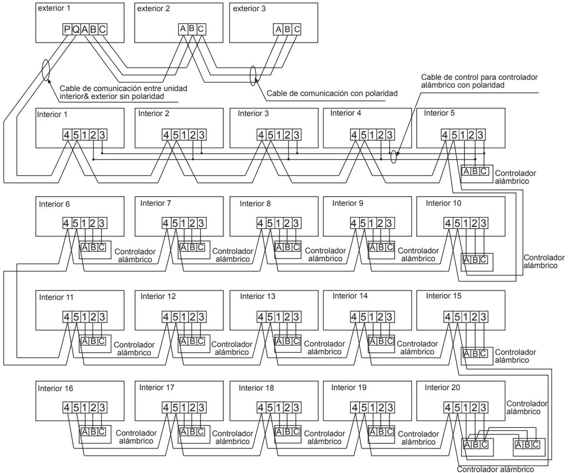
Las unidades exteriores están conectadas en paralelo mediante tres cables con polaridad. La unidad principal, el control central y todas las unidades interiores son de conexión paralela a través de dos cables sin polaridad.
