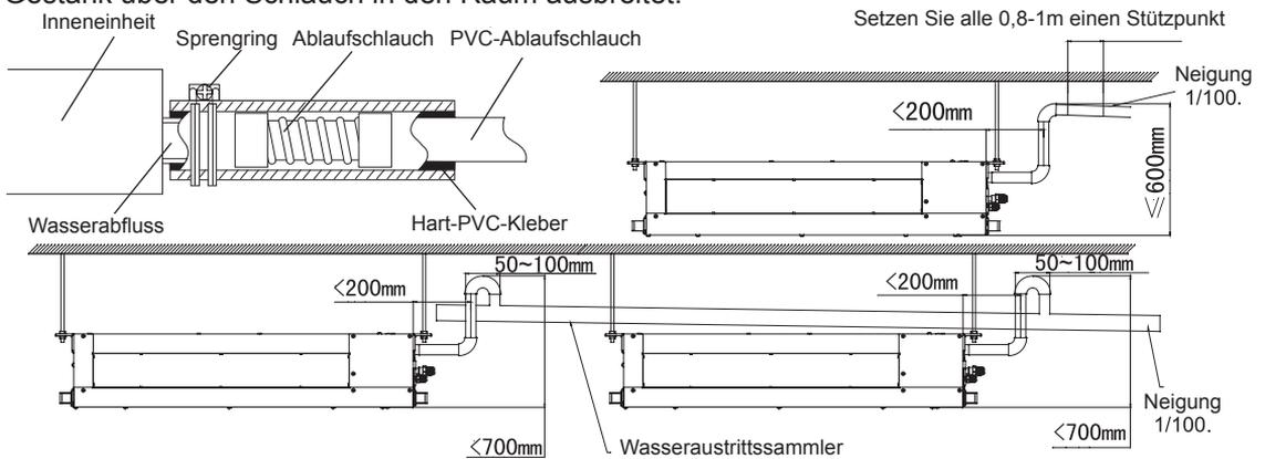
Mehrere Einheiten verwenden Wasseraustrittssammler zur Ableitung des Wassers in den Abflussgraben
