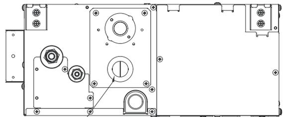
Ruotando il tappo del foro per aprire o chiudere il foro di iniezione dell'acqua
