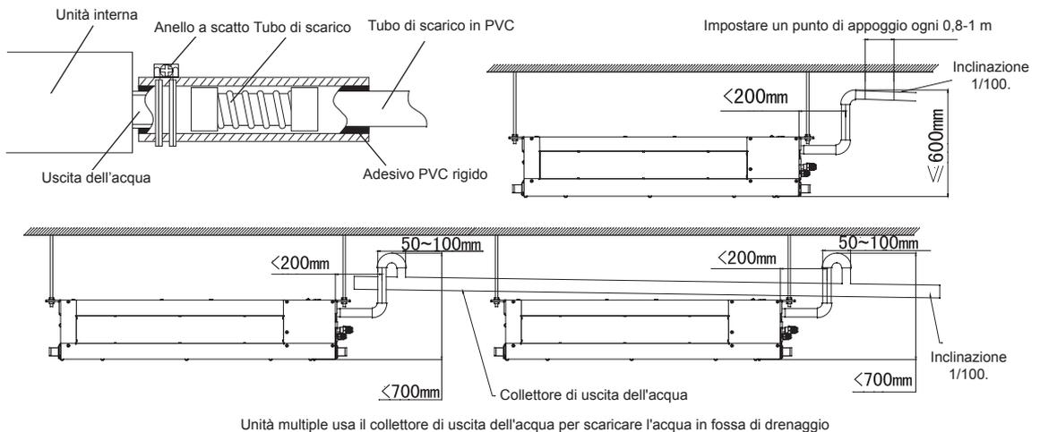
Unità multiple usa il collettore di uscita dell'acqua per scaricare l'acqua in fossa di drenaggio
