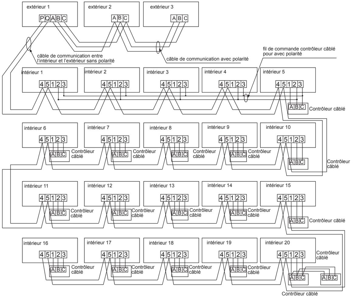
Les unités extérieures sont de la connexion parallèle via trois lignes avec polarités. L'unité principale, le contrôle central et les unités intérieures sont de connexion parallèle via deux lignes sans polarité.
