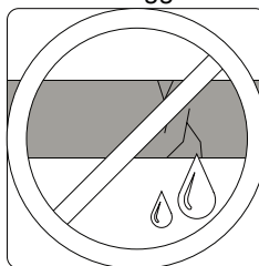
Verificare la presenza di perdite
