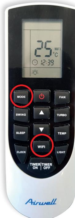
Appuyer simultanément sur les boutons « **WiFi** » et « **MODE** » de la télécommande, pendant 1 seconde en direction du display de l'unité intérieure, vous devez entendre un signal sonore qui vous avertira de la réinitialisation puis cliquer sur « Suivant » pour terminer liaison de l'application et l'unité intérieure.
