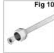
Fig. 10 Per prevenire fughe di refrigerante è bene unte le filettature con olio di refrigerazione
