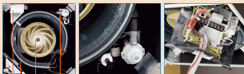
Prise d'air neuf Pompe de relevage de condensat Turbine à faibles niveaux sonores Coffret électrique coulissant Pompe de relevage de condensat en série. Hauteur de relevage jusqu'à 600 mm. 1 seul point de fixation pour faciliter la maintenance. Accès direct à tous les raccordements électriques et composants électroniques montés sur support tiroir.
