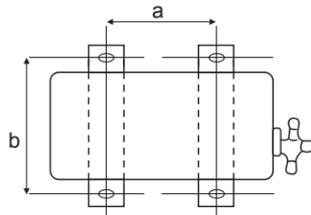
2. Per l'installazione sul tetto, tenere in considerazione vento e terremoti. Fissare l'unità con bulloni o chiodi.
