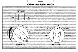
Cuando Vd. ajuste el termostato a la posición deseada, èste controlarà automàticamente la temperatura interna. La temperatura del aire interno serà reducida cada vez màs con cada vuelta en el sentido de las agujas de reloj.
