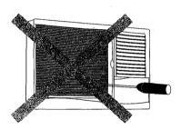
Ni delgadas puntas ni objetos similares deben ser introducidos en la entrada de aire o en la grilla de salida del aire, cuando la unidad está en funcionamiento.
