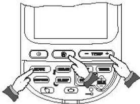
Der Kühlmodus kann durch Drücken des Betriebsartenschalters (2) gewählt werden. Durch Drücken des Schalters (4) kann entweder die gewünschte Ventilatorgeschwindigkeit eingestellt oder auf Ventilatorautomatik geschaltet werden. Wählen Sie die geeignete Temperatureinstellung. Bei Wahl des Kühlmodus stellt sich die Luftjalousie zur Belüftung automatisch in die horizontale Lage, die für den Kühlungsprozesses optimal ist.
