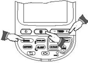
Wählen Sie den Automatikmodus, indem Sie die Modustaste (2) drücken. Durch Drücken der Taste (4) können Sie entweder auf Ventilatorgeschwindigkeit oder aber auf Ventilatorautomatik umschalten. Stellen Sie geeignete Temperatur ein. Die Luftjalousie stellt sich beim Kühlungsprozeß automatisch auf horizontale und beim Heizungsprozeß auf vertikale Luftfuhr um. Zu Beginn wählt das Klimagerät die Betriebsart, die der Zimmertemperatur und der Temperatureinstellung entspricht.
