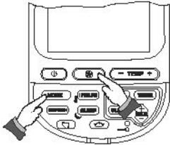
Der Ventilatorsmodus kann durch Drücken des Betriebsarten-Schalters (2) (MODE) gewählt werden. Durch Drücken der Ventilatorgeschwindigkeitstaste (4) kann die gewünschte Ventilatorgeschwindigkeit eingestellt werden.
