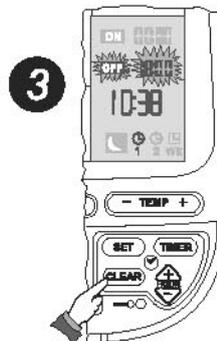
Die Einschaltzeit wird gelöscht. Das Symbol **OFF** (AUS) und die Ziffern der Ausschaltzeit blinken.
