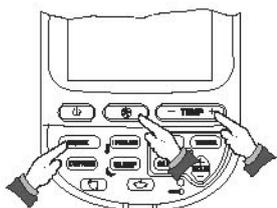
Der Heizmodus kann durch drücken des Betriebsartenschalters (2) gewählt werden. Durch Drücken des Schalters (4) kann entweder die gewünschte Ventilatorgeschwindigkeit eingestellt oder auf Ventilatorautomatik geschaltet werden. Wählen Sie die gewünschte Temperatureinstellung. Die HOT KEEP Funktion ist vorgegeben, der Ventilator schaltet sich aus, wenn die Temperatur der inneren Wirkung nicht heiss genug ist, um unangenehme, kalte Luftzüge zu verhindern.
