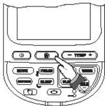
Dieser Vorgang beginnt mit dem stärksten Luftstrom, um die Zimmertemperatur schnell zu senken. Danach wird automatisch auf einen niedrigen Luftstrom umgeschaltet, um die gewünschte Temperatur beizubehalten.
