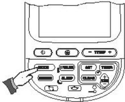
Wählen Sie durch Drücken der Modustaste (2) den Trocknungsmodus. Im Trocknungsmodus arbeitet das Klimagerät in einer niedrigen Ventilator Geschwindigkeit, auch wenn die LCD Anzeigentafel eine andere Ventilatoreinstellung anzeigt. Zur Vermeidung einer Überkühlung wird der Ventilator von Zeit zu Zeit abgestellt. Wird der Trockenmodus ausgewählt, stellt sich die Luftjalousie automatisch in die horizontale Luftzufuhrposition.
