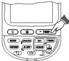
Drücken Sie die Temperaturtaste (TEMP) (5), um die Temperatureinstellung auf der LCD Anzeigentafel (13) zu ändern. Die Temperatureinstellung wird in Grad Celsius angezeigt. Eine höhere Zahl zeigt eine höhere Zimmertemperatur an.
