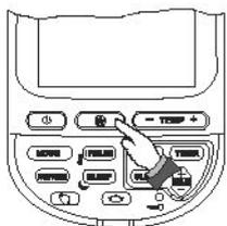
Dieser Vorgang beginnt mit dem stärksten Luftstrom, um die Zimmertemperatur schnell zu erhöhen. Danach wird automatisch auf einen niedrigen Luftstrom umgeschaltet, um die gewünschte Temperatur beizubehalten.
