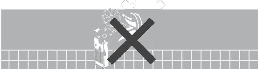
Wenn das Klimagerät in Betrieb ist oder gerade abgeschaltet wurde, kann unter Umständen ein leichtes Summen zu hören sein. Dieses entsteht durch das Zirkulieren des Kältemittels im Klimagerät.
