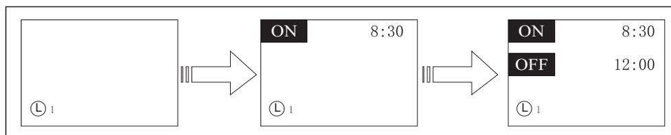
2. T2 enthält die zweite Zeiteinstellung für Start und Ende der Timerfunktion an Werktagen.
