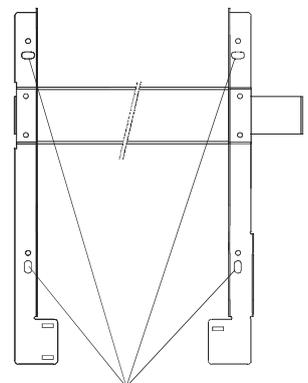
Position der Gewindestangen (Durchm. max. 8 mm) bei der Deckenmontage
