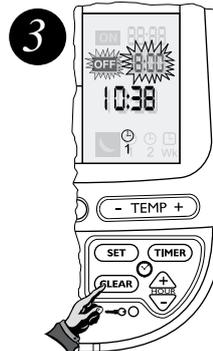
*Die Einschaltzeit wird gelöscht. Das Symbol **OFF** (Aus) und die Ziffern der Ausschaltzeit blinken.*
