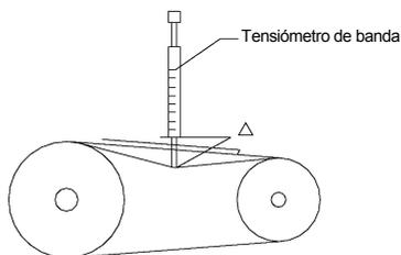
Utilización del tensiómetro de banda
