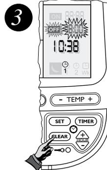
L'heure de mise en marche est effacée. L'icône OFF (Arrêt) et les chiffres de l'heure d'arrêt clignotent.
