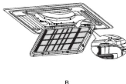
2. Nehmen Sie das Ansauggitter ab (zusammen mit dem Luftfilter, wie in Abb. B gezeigt). Ziehen Sie das Gitter in einem Winkel von 45° nach unten und heben Sie es nach oben aus.
