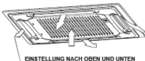
Wenn diese Funktion aktiv ist, läuft der Antriebsmotor der Luftlenklamelle am Innenteil, sonst läuft der Motor nicht.
