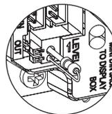
Cambiar el hilo de sonda por la resistencia de 4.7 KW
