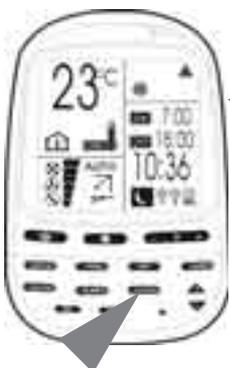
3. Die CLEAR-Taste drücken. Die Einschaltzeit wird gelöscht. Das Symbol OFF (Aus) und die Ziffern der Ausschaltzeit blinken.
