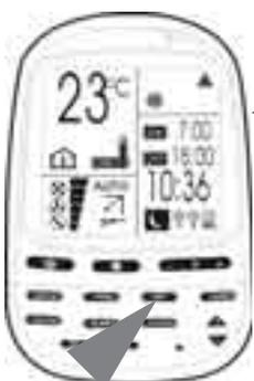
3. Die SET-Taste drücken. Das Symbol ON und die Ziffern der Einschaltzeit leuchten. Das Symbol OFF und die Ziffern der Ausschaltzeit blinken.
