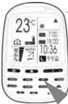
4. Die SET-Taste drücken, um die neue Einstellung zu speichern. Das Symbol ON und die Ziffern der Einschaltzeit leuchten, das Symbol OFF (Aus) und die Ziffern der Ausschaltzeit blinken.
