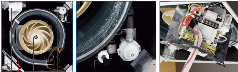
Prise d'air neuf Turbine à faibles niveaux sonores Coffret électrique coulissant Pompe de relevage de condensat Pompe de relevage de condensat en série. Hauteur de relevage jusqu'à 600 mm. 1 seul point de fixation pour faciliter la maintenance. Accès direct à tous les raccords électriques et composants électroniques montés sur support tiroir.
