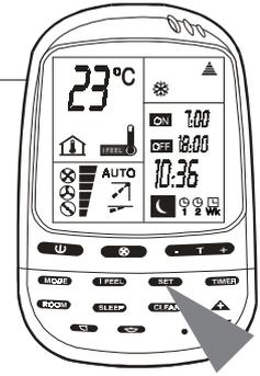
3. Die CLEAR-Taste drücken. Die Einschaltzeit wird gelöscht. Das Symbol OFF (Aus) und die Ziffern der Ausschaltzeit blinken.
