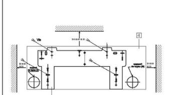
Le bord du carton d'installation ne devrait pas être à plus de 50 mm à droite et à gauche du mur.
